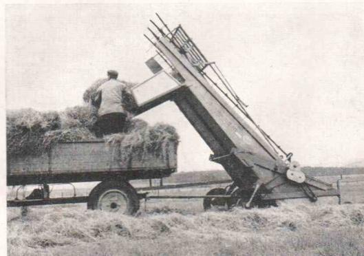
Abb. 4 Die lange Abwurfwanne ragt weit über den Wagen und erleichtert dadurch die Verteilung.
