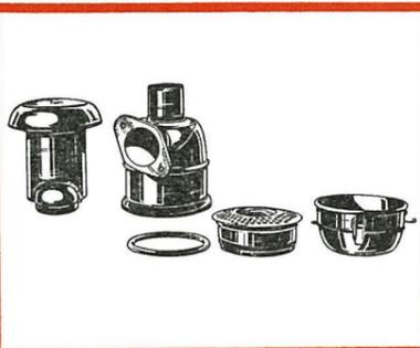
**FILTRE A AIR** - Nettoyer l'ensemble du filtre, et remettre de l'huile neuve dans la cuve: SHELL ROTELLA T 20/20W l'hiver, SHELL ROTELLA T 40 l'été.
