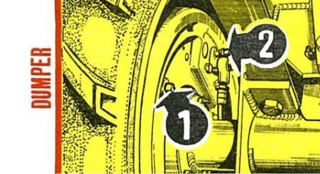
**TUYAUTERIE DE LA POMPE A HUILE** - Démonter et nettoyer à l'essence, puis souffler à l'air comprimé l'intérieur de la tuyauterie 1.
