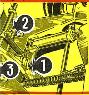
**ROTATION DU CHASSIS AVANT** - Vérifier les articulations du levier de commande de benne - Injecter de la graisse SHELL RETINAX A par les graisseurs 1, 2 et 3.
