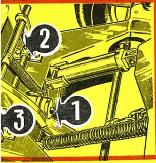
**BOITES DE ROTATION DU CHASSIS AVANT** - Desserrer le bouchon 1 et contrôler le niveau de l'huile. Si nécessaire, ajouter la quantité manquante par le bouchon 2 et 3.
