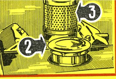
**CARTER MOTEUR** - Procéder au remplissage du carter moteur par l'orifice 2 après desserrage du reniflard 3: SHELL X 100 20/20W l'hiver, SHELL X 100 30 l'été.
