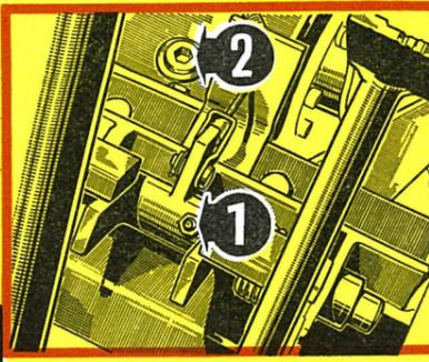
**AXE D'ARTICULATION DES PÉDALES DE COMMANDE** - Injecter de la graisse SHELL RETINAX A par le graisseur 1.
