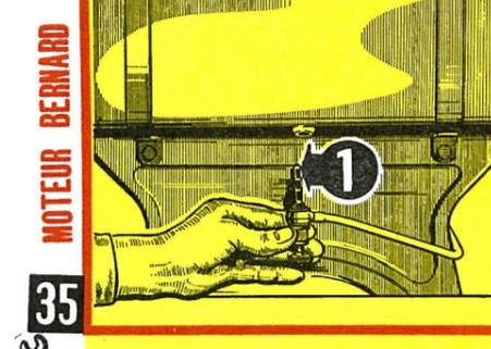
**FILTRE A CARBURANT** - Démonter le robinet équipé de son filtre, puis brosser et souffler à l'air comprimé le tamis 1.
