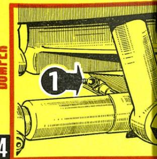
**CABLE DE COMMANDE DE MAIN** - Injecter de la graisse SHELL RETINAX A par le graisseur 1.
