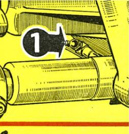
**CABLE DE COMMANDE DE MAIN** - Injecter de la graisse SHELL RETINAX A par le graisseur 1.
