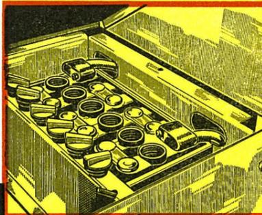
**BATTERIE** - Parfaire le niveau dans les éléments avec de l'eau distillée (5 mm au-dessus des plaques).
