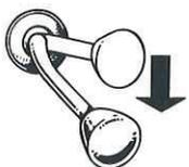
La boîte de vitesses étant équipée d'un dispositif de synchronisation, on peut passer de 3<sup>e</sup> en 4<sup>e</sup> vitesse ainsi que de 7<sup>e</sup> en 8<sup>e</sup> vitesse, le tracteur avançant.
