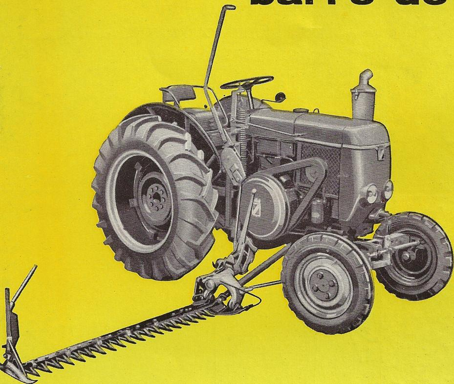
**S**PÉCIALEMENT étudiée pour le tracteur 201, la barre de coupe "SFV" portée latéralement donne une excellente visibilité de travail et une grande facilité de conduite. Le mouvement de la lame est assuré par un dispositif commandé directement à partir de l'arbre de prise de force et enfermé dans un carter fixé sous la boîte de vitesse du tracteur.
