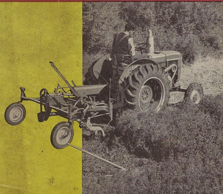
Les roues arrière montées sur fusées pivotantes autorisent toutes les manœuvres et confèrent à l'ensemble tracteur-faucheuse une grande maniabilité.
