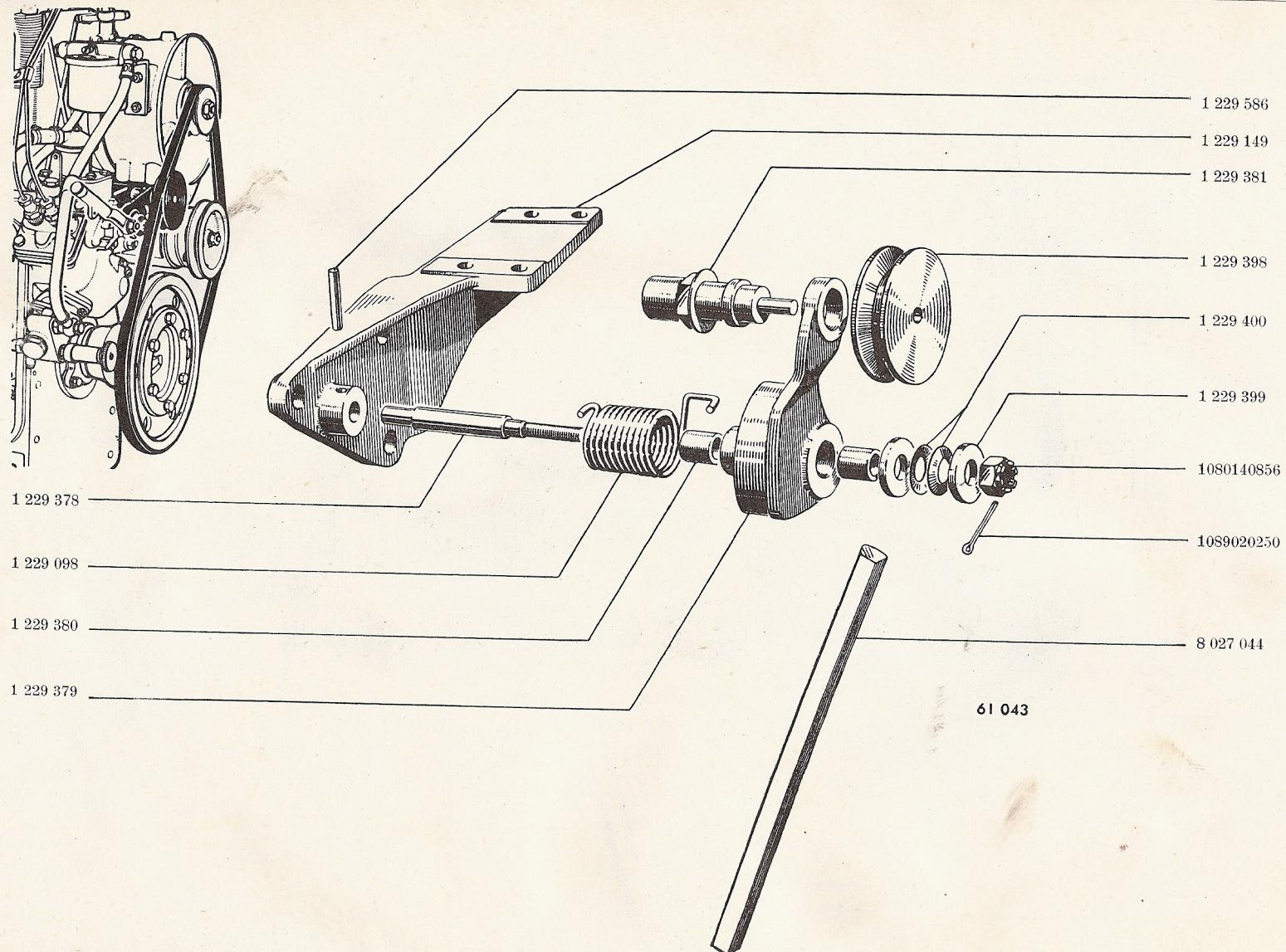
Support de turbine. Tendeur de courroie - R. 7 052
