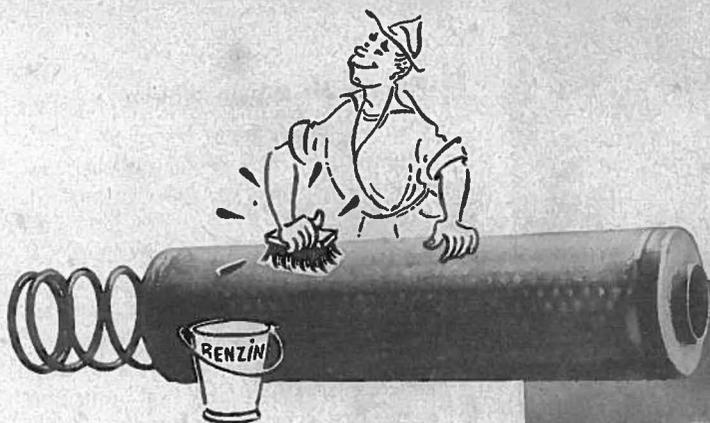
2. Mettre le piston du cylindre correspondant au filtre au point mort haut. Pour le A 122 c'est le premier cylindre; pour le A 133 le cylindre central et pour le A 144 le troisième cylindre. Enlever le couvercle du carter moteur. Sortir le tamis d'huile vers l'arrière en agissant sur son ressort de retenue. Nettoyer le tamis en le barbotant dans de l'essence et le remettre sur le tuyau de la pompe.
