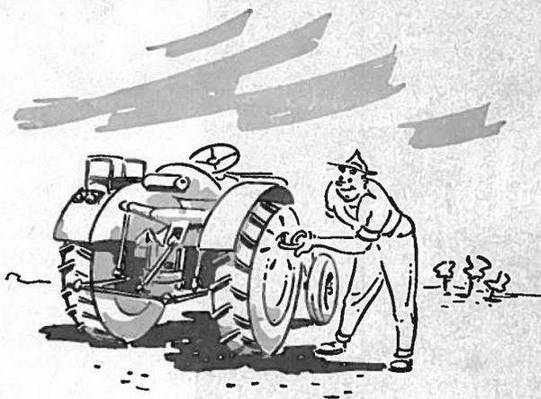
Un conseil: Pour réduire l'usure des pneumatiques réduire seulement la pression au début du travail sur le champ. Bien entendu il faut regonfler les pneumatiques à la pression route dès que les travaux sur le champ est terminé. Pour le gonflage il existe des pompes appropriées p. e. des pompes se montant sur la prise de force du tracteur.
