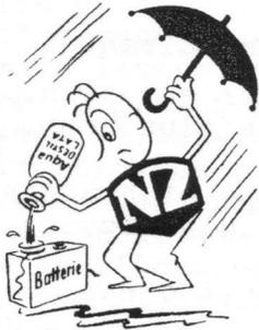
d'acidité de l'électrolyte. Le niveau du liquide doit dépasser les plaques d'environ 15 mm. Si le niveau est plus bas remplissez les bacs avec de l'eau distillée, n'employez jamais de l'eau bouillie ou de l'eau de pluie. Il ne faut compléter avec de l'eau acidulée que si du liquide a été renversé, car normalement c'est seulement
