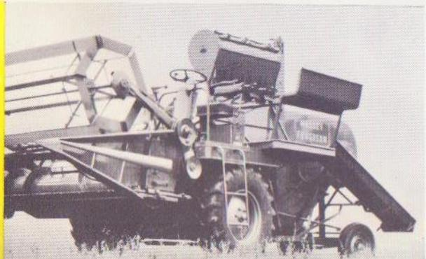
La presse à paille est du type à piston oscillant. Sa capacité en balles est suffisamment élevée pour ne pas ralentir le fonctionnement de l'automotrice quel que soit le rendement de la récolte. Equipée de deux noueurs, elle permet d'obtenir des balles de moyenne densité de 1 m de large x 0,35 m d'épaisseur.
