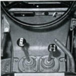
**Transmission mécanique.** 8 vitesses avant + 4 arrière. Boîte de vitesses entièrement synchronisée, 3 gammes: route — champ — arrière, Prises de force autonomes.
