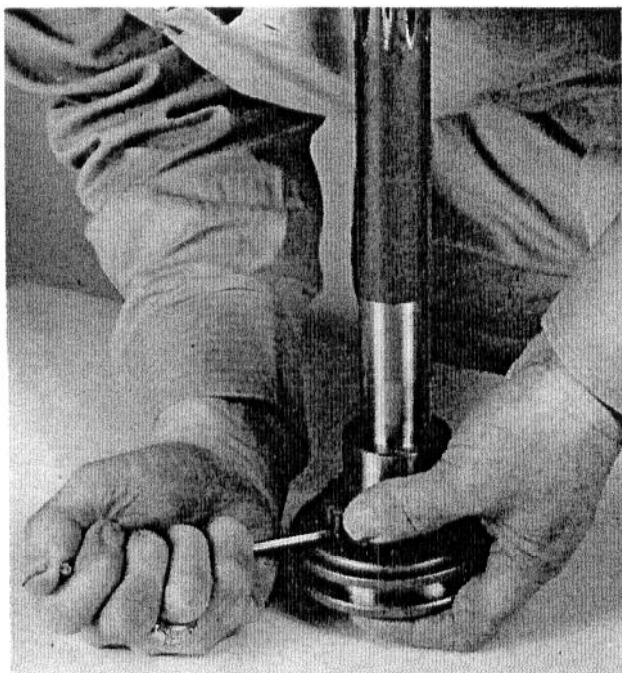
Fig. 9 - Installing Shift Collar Over Detents
