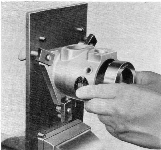
Fig. 44 Démontage de la came annulaire
