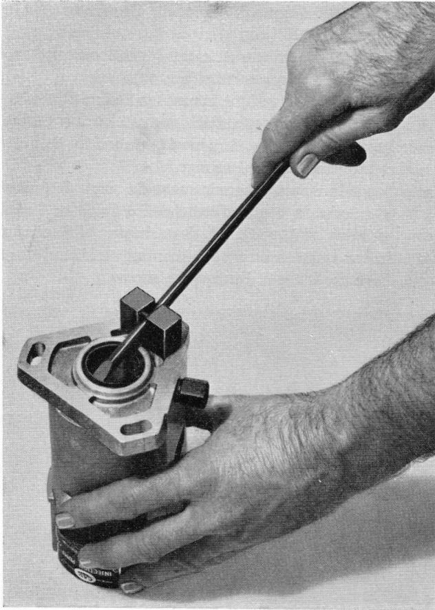
Fig. 30 Extraction du joint d'étanchéité du moyeu de pompe
