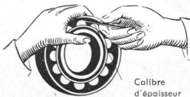
Fig. 1 Contrôle d'un roulement à rouleaux
