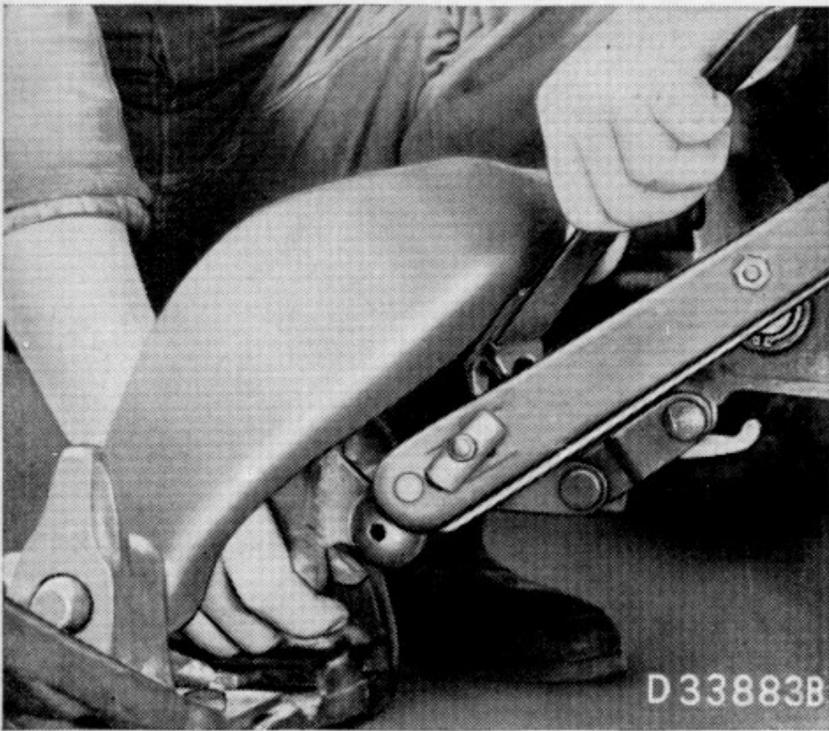
Bild 188. Spreizen der Klemmlöffel
