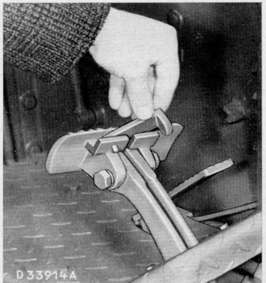
Bild 85. Verriegeln der Bremsfußhebel
