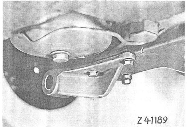
A l'aide des trois vis de fixation munies de rondelles Grower, fixer la console arrière sur la face intérieure de la boîte de vitesses.
