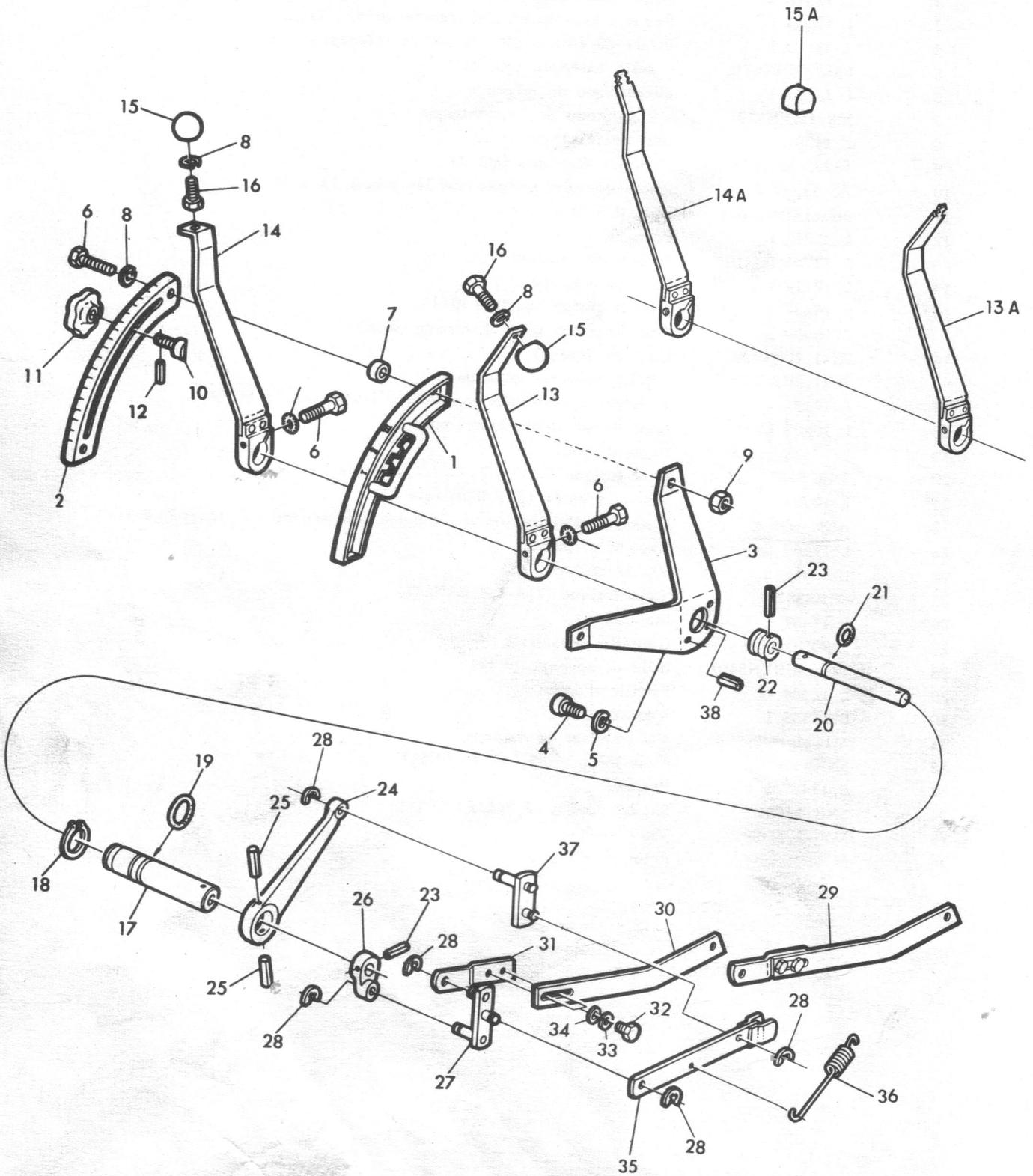
DISTRIBUTEUR DE RELEVAGE HYDRAULIQUE
