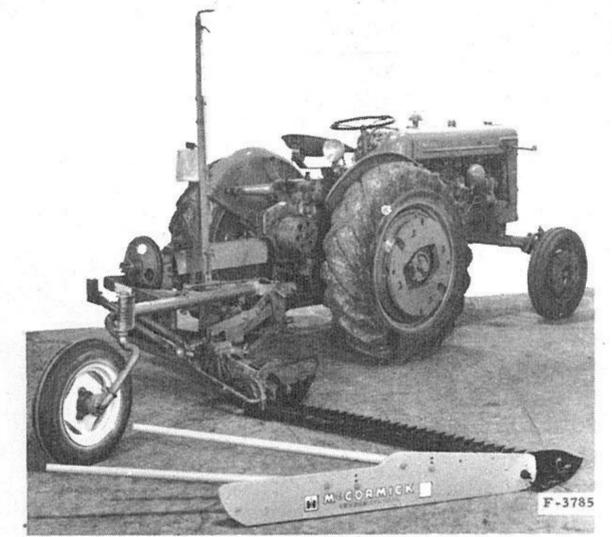
FAUCHEUSE SEMI-PORTEE F-21 U montée derrière Utility SERIE 235. Cette machine peut être semi-portée derrière toutes marques de tracteurs.
