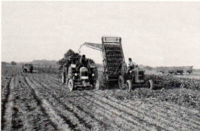
„Universal“ Lader mit Querband beim Laden von Zuckerrübenblättern. Keine Person ist auf dem Wagen notwendig
