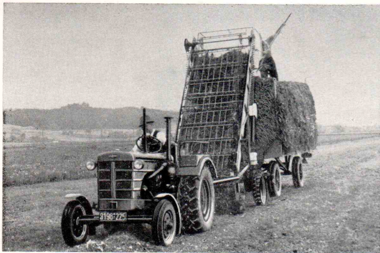
„Universal“ Lader mit Längsband beim Laden von Halbheu
