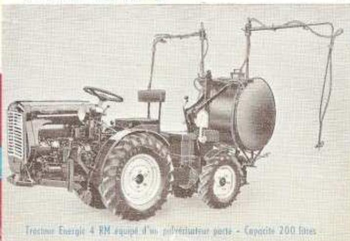
Tracteur Energie 4 RM équipé d'un pulvérisateur portable - Capacité 200 litres
