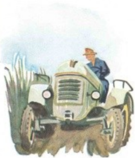
Das bekannte BAUTZ-Mähwerk mit dem springenden Aufzug. Direkter Antrieb vom Getriebe aus. Sicherheitskupplung. Außerordentlich schneller An- und Abbau. (Sonderausrüstung.)
