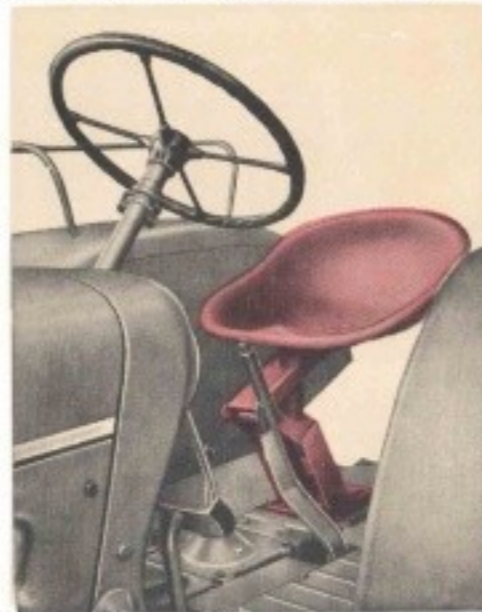
Der gut gefederte, verstellbare Sitz bewirkt eine zwanglose Körperhaltung des Fahrers und vermeidet vorzeitige Ermüdungserscheinungen.
