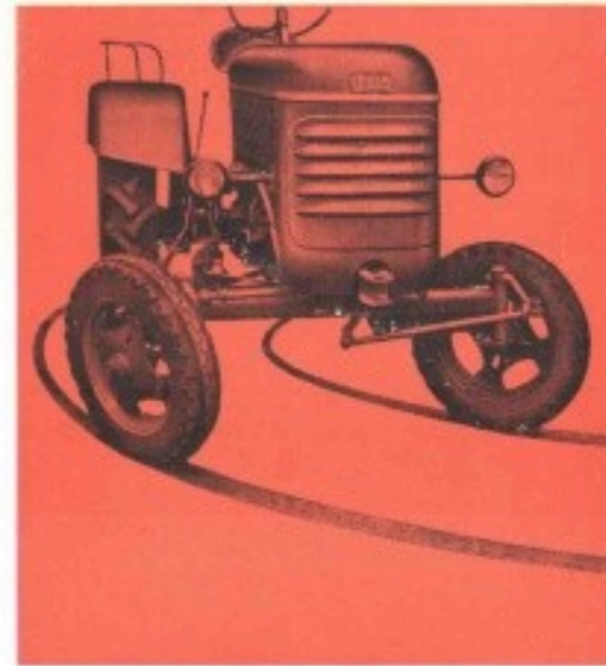
Die vielbeachtete V-Lenkung läßt einen so großen Radeinschlag zu, daß beinahe ein Drehen um das innere Hinterrad ermöglicht wird. Trotz des großen Einschlags setzt sich die Lenkung niemals fest.
