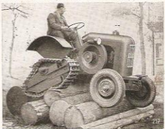
Le tracteur R 22 muni de ses chenilles amovibles le transformant en half-track et lui assurant une puissance au crochet beaucoup plus élevée
