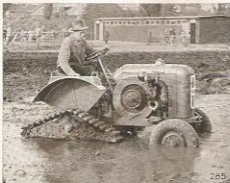
Le tracteur R 22 muni de ses chenilles amovibles le transformant en half-track et lui assurant une puissance au crochet beaucoup plus élevée
