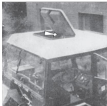
Trappe de la cabine bloquée en position ouverte par les bras télescopiques (fig. 125).
