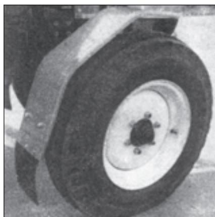
**Ailes avant pour les embouts élastiques à ressort (fig. 151)**
