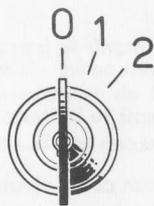
Fig. 25 - Positions de la clef de contact
