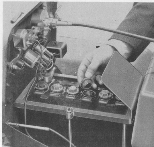
Fig. 23 - Contrôle du niveau de l'électrolyte
