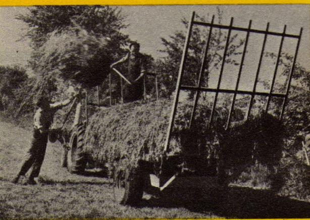
Remorque semi-portée type " CV 31 " de 3 tonnes, équipée en fourragère.
