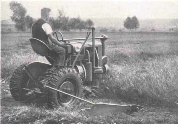
Mähbalken mit Antrieb über Zapfwelle mit Ratschkupplung, sehr leicht abnehmbar, mit automatischer Ausschaltung und Sperrung. 4½ Fuß Schnittbreite.
