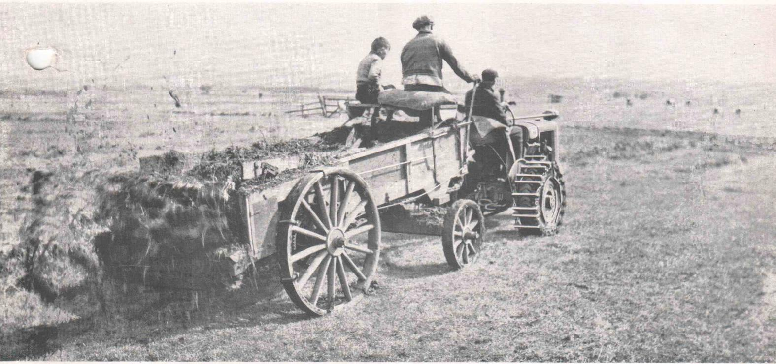
Ein ideales Gespann für den Bauern ist der Ritscher-Schlepper mit Stalldüngerstreuer. Die Verteilung ist hervorragend bis doppelte Wagenbreite, sogar bei halblangem Dünger.
