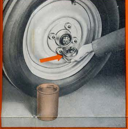
ROUES AVANT (Graisse roulement) Remplir le bouchon de graisse et le revisser.
