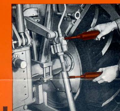
TIRANT A MANIVELLE (Graisse châssis)
