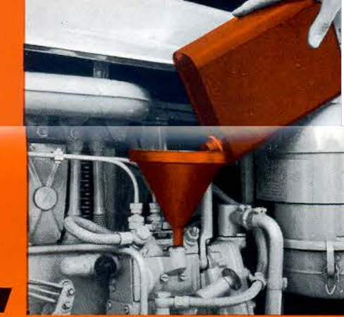
POMPE D'INJECTION Niveau (Huile moteur) L'huile doit affleurer l'orifice niveau.
