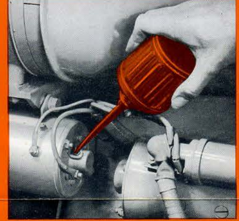
DYNAMO (Huile moteur) Introduire quelques gouttes d'huile dans le godet.
