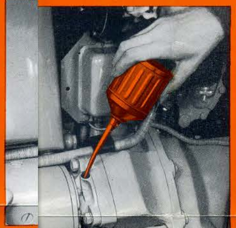
DEMULPLICATEUR (Huile moteur) Retirer la vis bouchon et introduire quelques gouttes d'huile.
