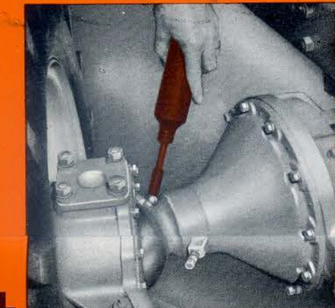
ROTULES DE FUSÉES (Graisse châssis)
