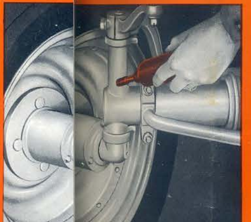
PIVOTS DE FUSÉES (Graisse châssis)
