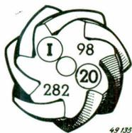
**Cas exceptionnel.** — Il peut arriver **exceptionnellement** que la cote **A** ne soit pas la cote de positionnement du pignon. La différence entre la cote réelle et la cote **A** est alors marquée sur la face avant du pignon à côté du marquage d'appariement. Elle est donnée en 100<sup>e</sup> : **exemple (20)**.
