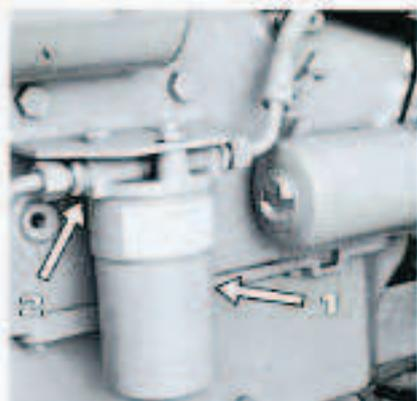
**Relevage hydraulique - direction :** pour changer la cartouche filtrante dévisser le corps (1). Au remontage le corps (1) ne doit pas être bloqué, amener celui-ci au contact du support (2).
