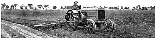
Le Tracteur " Mac Cormick " nouveau modèle 10-20 HP ne pèse guère que 1.600 kilos. Il fait merveille pour exécuter les travaux superficiels. On le voit ici avec un pulvérisateur en tandem et une herse.
