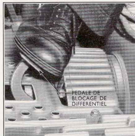
A condition qu'une roue adhère fermement, le blocage de différentiel monté sur le Super Major surmonte cette difficulté et permet d'obtenir une traction additionnelle de la roue qui est sur la partie ferme du terrain, et le tracteur peut ainsi passer l'endroit difficile.
