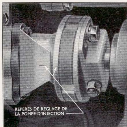
Fig. 19. Repères de Réglage de la Pompe d'Injection
