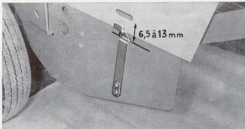
Fig. 12. — Jeu entre encoche et partie horizontale du ressort.
