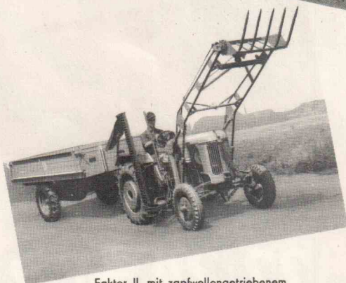
Faktor II mit zapfwellengetriebenem Einachsanhänger und Wittenburg-Frontlader mit Stallungsgabel.
