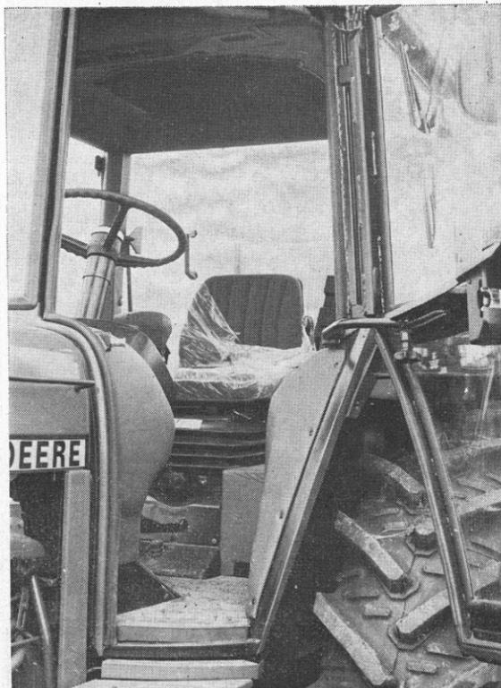
CETTE PHOTO MONTRE L'ACCESSIBILITÉ DE LA NOUVELLE CABINE JOHN DEERE « SG 2 ». L'escalier d'accès est monté très en avant et permet au conducteur de se présenter face au couloir formé par l'aile et le tableau de bord. La porte ouverte dépasse peu de la largeur hors tout du tracteur (Photo RTMA)
