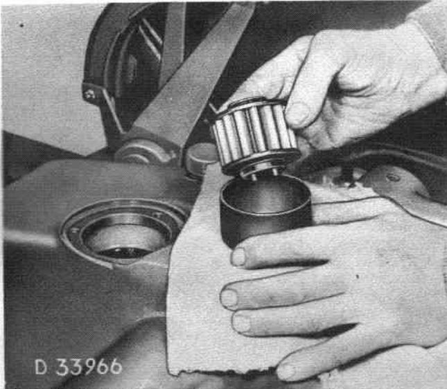
Fig. 122 - Démontage de l'élément filtrant
