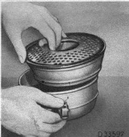
Fig. 96 - Dépose de l'élément inférieur du filtre à air
