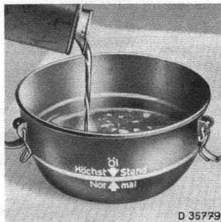
Fig. 97 - Remplissage de la cuve du filtre à air
