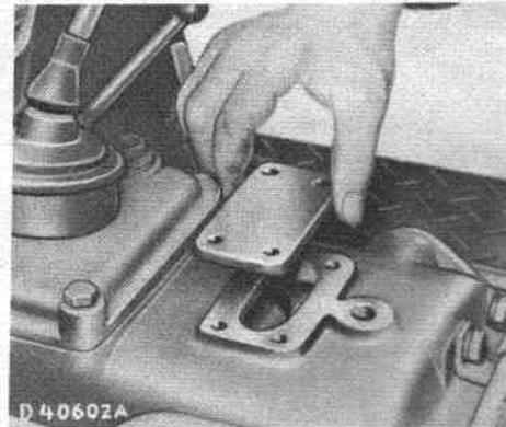
Fig. 137 - Démontage du couvercle
