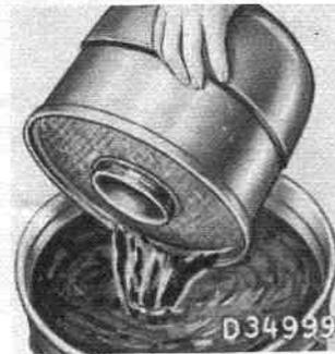
Fig. 142 - Lavage de la partie supérieure du filtre à air
