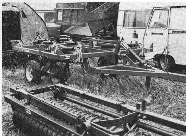
Sur le stand Gourdin Souplex, au premier plan le nouveau Cultipacker 8252. Le train avant de disques est suspendu par deux biellettes assurant son indépendance par rapport au train arrière et au châssis. Chaque train de disques est doté d'un palier central assurant la rigidité de l'arbre. A l'arrière-plan, le Chisel Cultivateur se fait en largeur de 2,80 m (10 dents) à 6,90 m (28 dents) (Photo RTMA)
