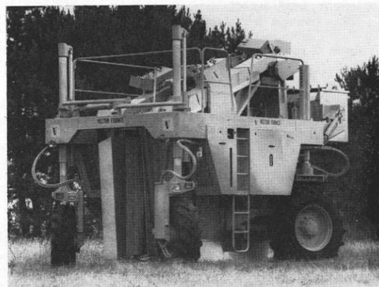
MONTAGE D'UN MOTEUR HYDRAULIQUE DE LA « SÉRIE 18 » DANS LA ROUE DE LA MACHINE A VENDANGER VECTUR
