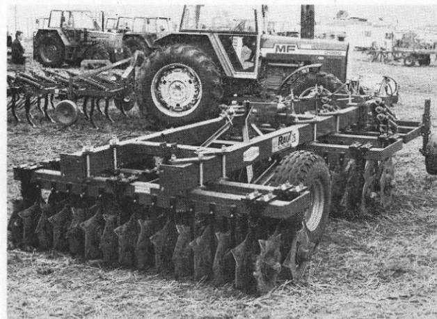
Pour la préparation des sols, Rau propose le « Multitiller » aux combinaisons multiples. Disponible en 6 versions de 2,5 m à 4 m avec différents outils, il nécessite des puissances de 100 à 180 ch. Pour les puissances inférieures, il fournit le « Rototiller », houe rotative disposant d'un choix varié de rotors (Photo RTMA)
