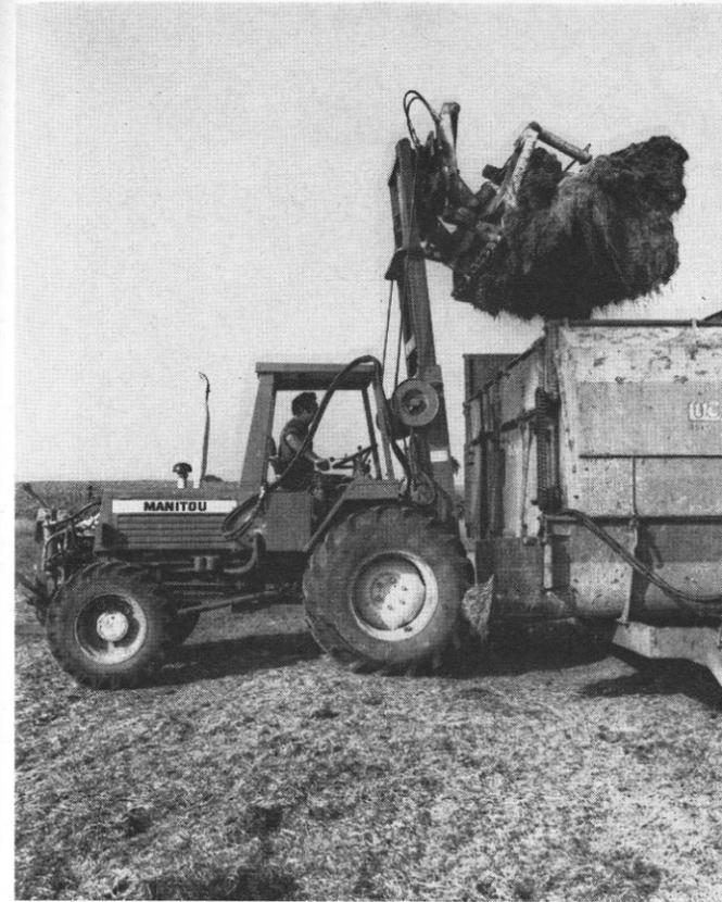
MANITOU ÉQUIPÉ D'UNE FOURCHE MULTIGRIFFES À L'AVANT ET D'UN ATTELAGE TROIS POINTS À L'ARRIÈRE
