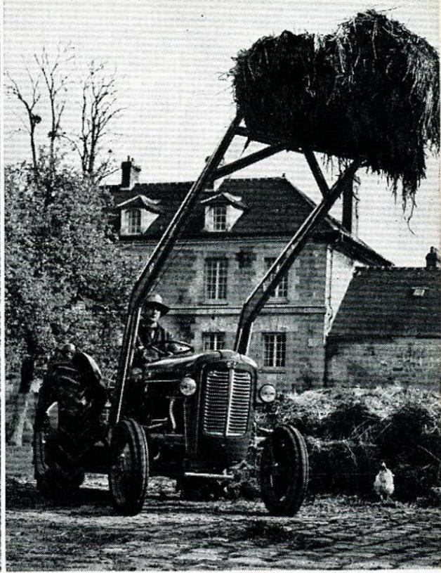
Le système hydraulique du MASSEY-FERGUSON 35 peut basculer facilement les 5 tonnes de betteraves contenues dans cette remorque, comme il manœuvrera avec souplesse le chargeur frontal que l'on voit ici transportant du fumier rapidement et avec aisance.
