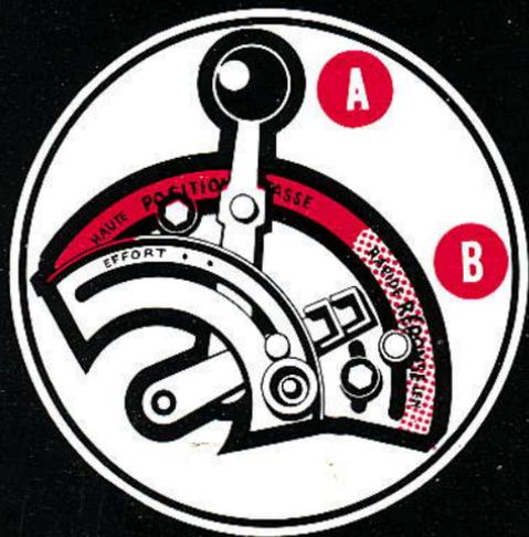
**A** Le levier intérieur est le plus long; il est terminé par une boule (manette A du manuel d'instruction, fig. 42 et suivantes). Il peut se déplacer sur un secteur de grand diamètre. C'est surtout un levier de commande.
