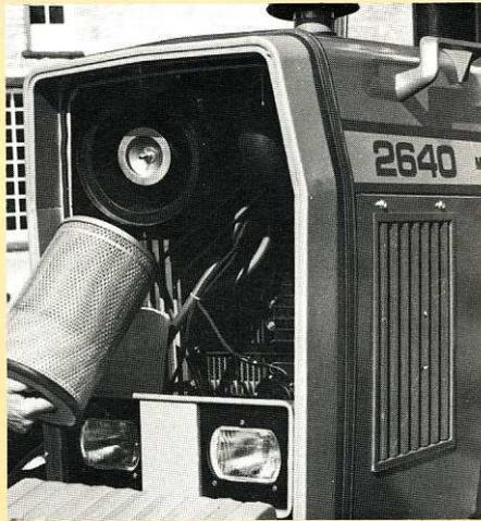
La "calandre MF" est aisément démontable par 1 crochet. On accède ainsi au filtre à air à 2 éléments.
