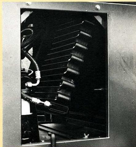
De chaque côté du capot une grille entièrement démontable permet un accès parfait aux radiateurs.
