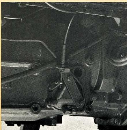
La commande d'inverseur et de multiplicateur de vitesse se fait grâce à 1 seul levier situé au-dessus du levier de boîte.
