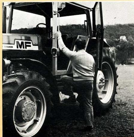
La parfaite visibilité vers l'avant assure au conducteur un travail plus précis. D'un coup d'œil, il surveille ses passages de roues sans se pencher ou se contorsionner. Cette visibilité est un élément non négligeable du confort. Aucun obstacle, pas même le pot d'échappement spécialement dessiné, ne gêne la vue vers l'avant.
