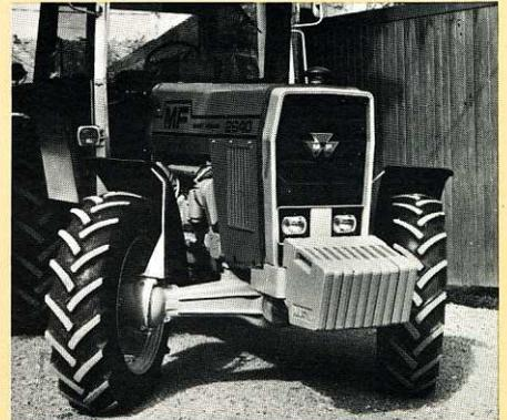
Les réductions épicycloïdales sont robustes et peu encombrantes : elles assurent une excellente adhérence. Le réglage des voies est obtenu par les différentes positions de fixation du voile acier sur les pontets et par retournement du voile : voies de 1,60 m à 2,07 m.
