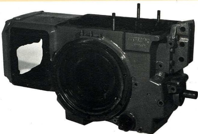
Le tracteur possède un essieu arrière fortement dimensionné tant au niveau du carter pont que des trompettes et arbres de roues.
