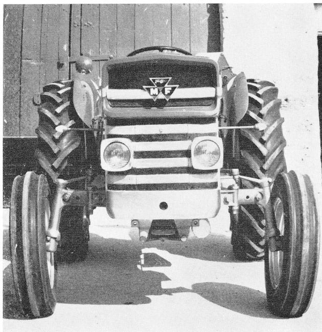
Les phares, totalement intégrés dans la calandre, présentent des caractéristiques nouvelles. Le verre de phare est protégé par une visière éliminant les risques de bris. Les ampoules sont à filaments double donnant un faisceau phares et un faisceau code, type européen.
