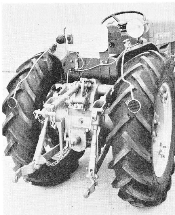
Un montage particulier, très rapidement adaptable, permet d'utiliser sur le 130 « Vigneron » la plupart des instruments du tracteur standard. Il suffit pour cela d'amener la voie arrière du tracteur à 1,07 m ou au-delà et d'écarter les barres d'attelage par l'adjonction de 2 pièces spéciales qui augmentent l'entraxe des points supérieurs d'attelage des tirants de relevage, et autorisent ainsi le montage de la barre à trous standard entre les rotules des bras inférieurs.
