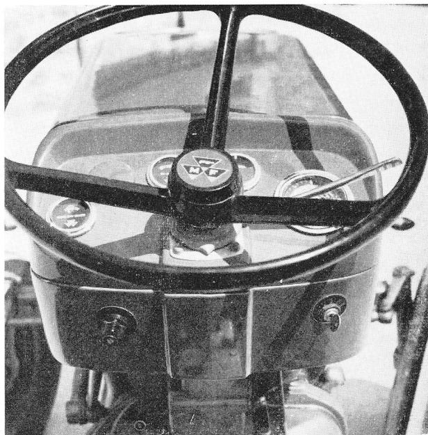
**d) le capot** : est de couleur rouge avec flancs blancs. La partie supérieure se relève en entier en pivotant sur le côté droit et découvre largement le réservoir, le radiateur et la batterie ; cette dernière pouvant être facilement déposée en la faisant glisser sur son support.
