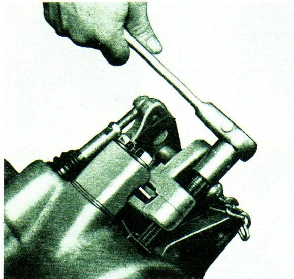
3° Débloquer le contre-écrou B de la tige plongeuse A et l'allonger (ou la raccourcir) jusqu'à obtenir un jeu de 5/100 entre la commande de contrôle de profondeur et la valve principale (fig. 20).
