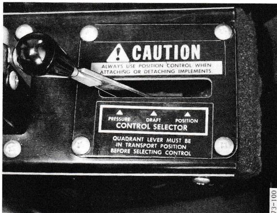
Figure 42 - Manette de sélecteur en modulation de pression
