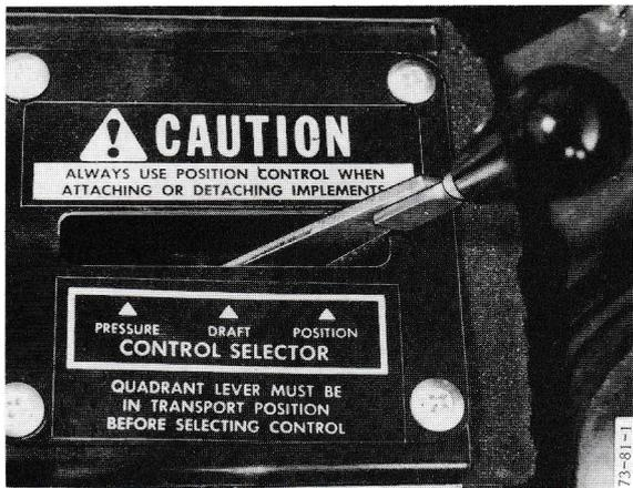
Figure 40 - Manette de sélecteur en contrôle de position
