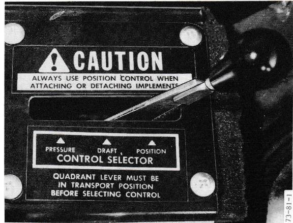
Figure 16 - Sélecteur en contrôle de position
