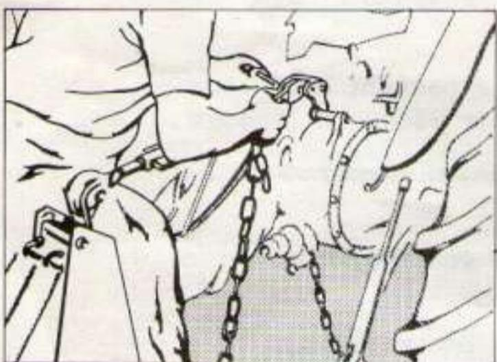
Fig. 2 - MISE EN PLACE DE LA LANTERNE DE REGLAGE
