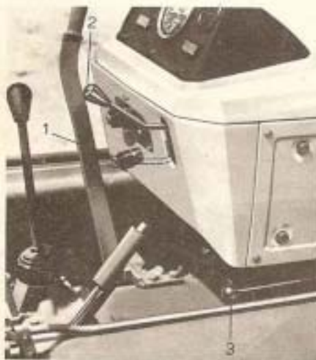
fig. 2 - Levier accélérateur 1) Position démarrage 2) Position de bas régime 3) Bouton d'arrêt du moteur (sous le tableau de bord)
