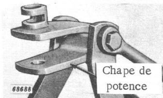
Sur tracteurs équipés du système d'attelage du type 800, fixer la barre de cet attelage dans la chape de potence du Gyramor prévue à cet effet. Utiliser les bagues sur les axes d'attelage.
