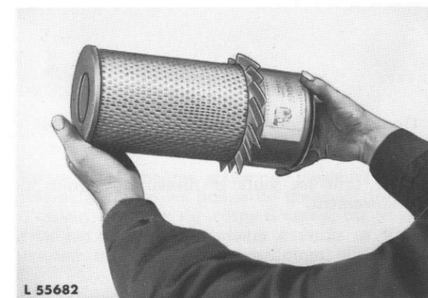
Si un nettoyage de la cartouche devient nécessaire pendant le travail, ceci peut être réalisé provisoirement, en frappant la cartouche contre la paume de la main. La nettoyer à fond, une fois le travail terminé.
