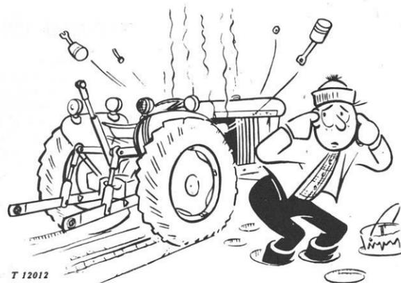
**IMPORTANT:** Ne jamais ajouter d'eau chaude lorsque le moteur est froid, ou d'eau froide lorsque le moteur est chaud. Ne jamais faire tourner, même pour quelques minutes, le moteur sans liquide de refroidissement.
