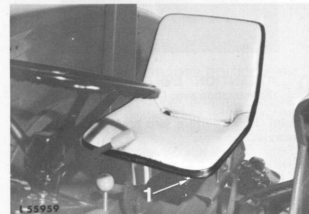
1 Desserrer les 2 **vis de fixation** du siège et régler ce dernier à la taille du conducteur.
