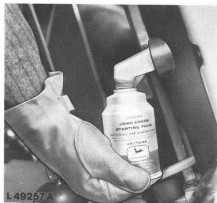
Placer la bombe sous l'embout et procéder à des injections de fluide brèves et répétées.
