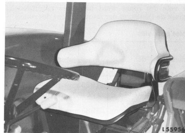
Le siège de luxe peut être réglé en long et en hauteur et suivant le poids du conducteur. Il peut également être relevé.
