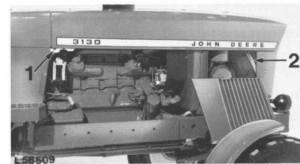
1 Dévisser les vis de fixation situées de chaque côté sous le capot, à l'arrière.
