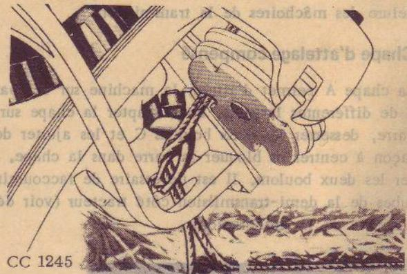
3. Le bec du noueur commence sa rotation lorsque la denture du plateau-came a entraîné le pignon de commande du disque ficelle et l'a fait tourner suffisamment pour que le reteneur de ficelle retienne les deux brins de ficelle dans le disque de ficelle.
