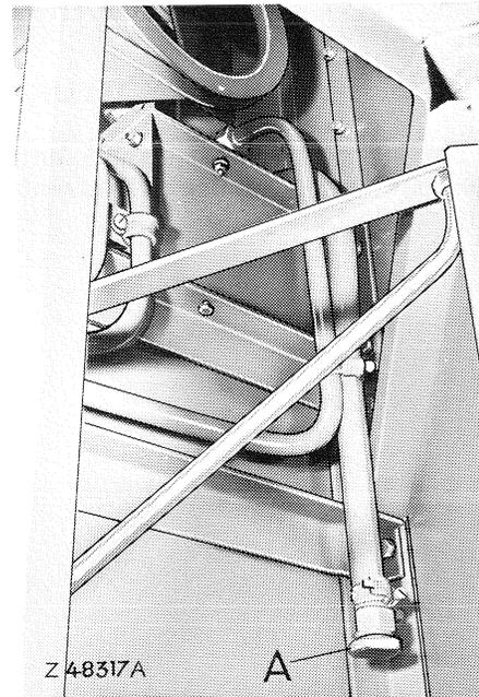
Tuyau de vidange du réservoir d'huile hydraulique.
