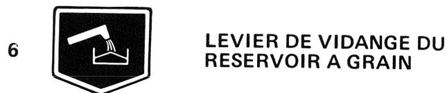
Ce levier met en marche la vis sans fin lorsqu'il est tiré vers le haut; pour l'arrêter, pousser le levier vers le bas. Le réservoir à grain peut être vidé lorsque la machine est arrêtée et que le moteur tourne car les deux entraînements sont indépendants.
