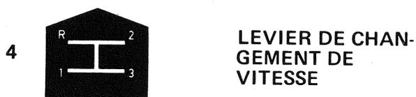
Il y a trois vitesses avant et une vitesse arrière. Les positions du levier pour les différentes vitesses sont montrées par le schéma. Ne pas changer de vitesse sous charge.
