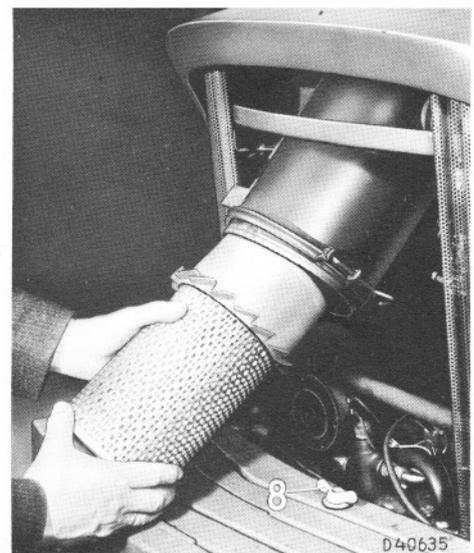
Fig. 6 - Démontage de l'élément filtrant
