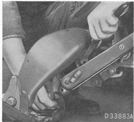
fig. 169 Ecarter les attaches de bielle
